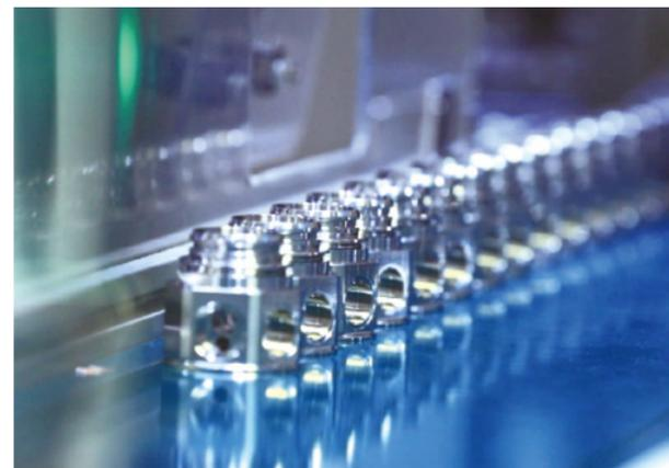
博世无锡生产的喷油阀，有很多清洗的工艺会用压缩空气和热水。利用能源管理系统（同时也是智能水管理平台）可以做到精准调节压缩空气和热水的用量，减少资源和能源的浪费。
